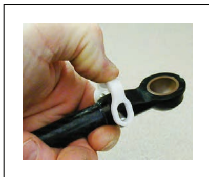
图 6-13. 将固定器推入到位
